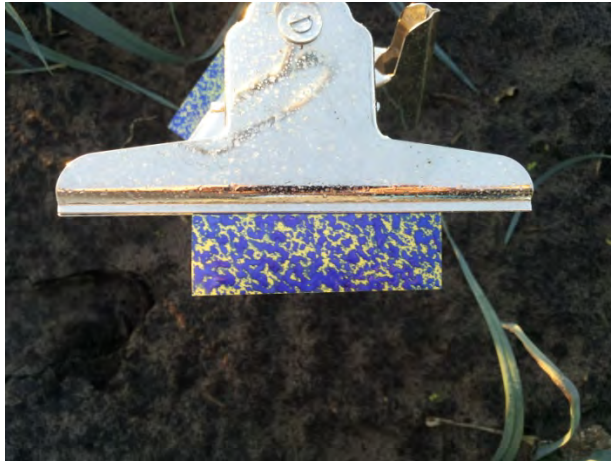
Het resultaat van de Airmix 110-04 met toevoeging van Squall
