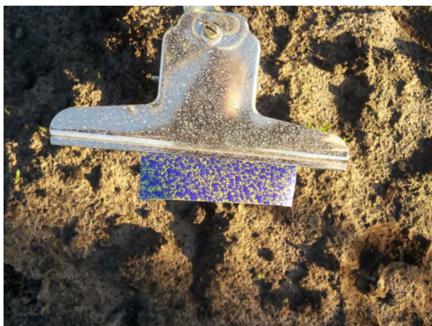
Het resultaat van de TTJ60 110-03 op watergevoelig papier
