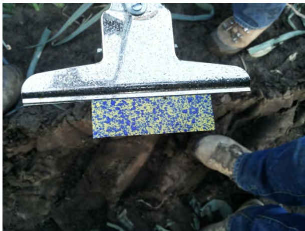
Het resultaat van het Agrifac HighTechAirPlus lucht-vloeistofstelsel
