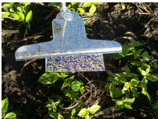
Resultaat van de WingsSprayer met Albuz CVI Twin 110-015 tweekamer venturi spleetdoppen
