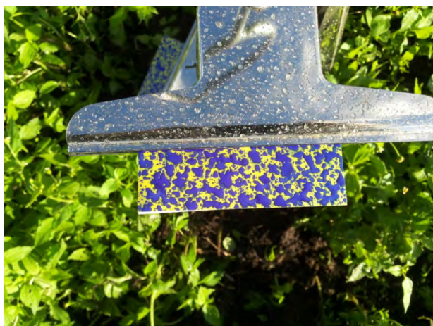
Resultaat van de WingsSprayer met Albuz CVI 110-015 doppen
