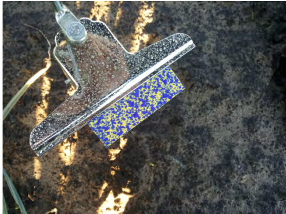
Het resultaat van de TurboDrop HiSpeed 110-025 op watergevoelig papier
